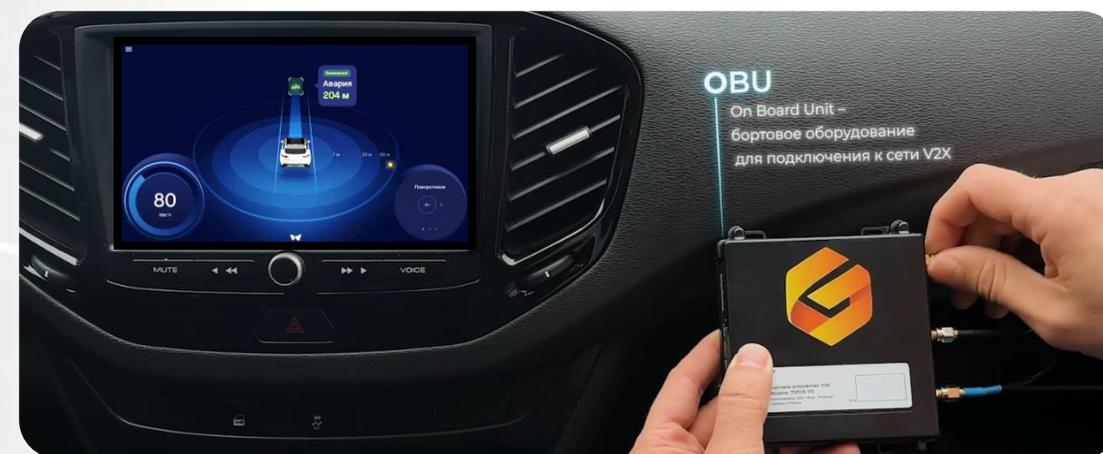
OBU обеспечивает прием информации и **выводит ее на монитор**
